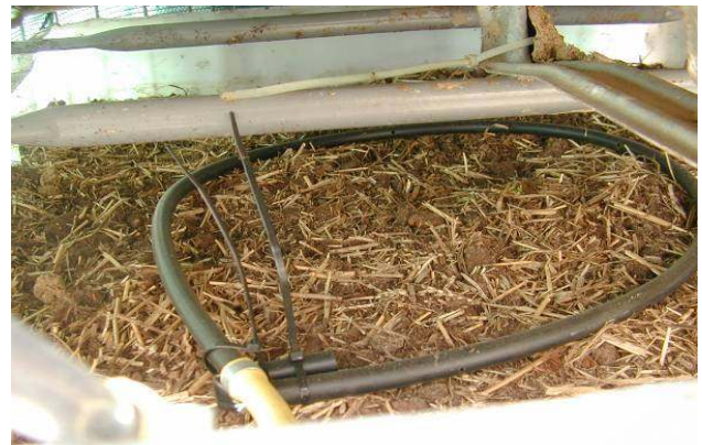
Abb. 21 + 22: Verteilung der kontaminierten Flüssigkeit auf der Oberfläche durch eine Metallplatte (links - Foto: CRAw) bzw. einen perforierten Schlauch (rechts - Foto: pcfruit)
