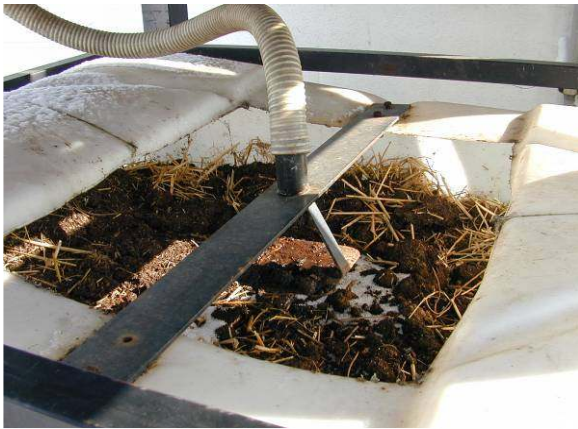
Abb. 21 + 22: Verteilung der kontaminierten Flüssigkeit auf der Oberfläche durch eine Metallplatte (links - Foto: CRAw) bzw. einen perforierten Schlauch (rechts - Foto: pcfruit)
