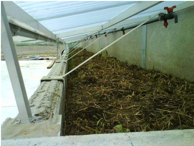
Abb. 23 + 24: Verteilung der kontaminierten Flüssigkeit auf der Oberfläche durch Spritzdüsen (links - Foto: POVLT) bzw. gebohrte Röhren (rechts - Foto: Bayer CropScience)
