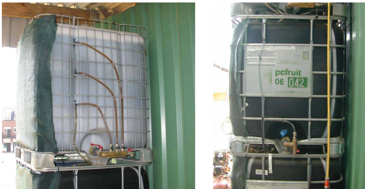
Abb. 35 + 36: Um eine optimale Feuchtigkeit zu gewährleisten, ist in zwei der oberen Einheiten des modifizierten Biofilters eine Sättigungszone am Boden der Einheiten gegeben. Hier kann das Wasser kapillar aufsteigen. Dies kann erreicht werden, indem am Auslass der Einheit ein Schlauch der aufwärts gebogen ist installiert wird. Dadurch entsteht eine Art Luftsäule zur Spitze hin. Die Höhe der wassergesättigten Zone ist von der Höhe dieses Luftschlauchs abhängig. Es können verschiedene Zonen realisiert (links), oder nur eine gesättigte Zone von 300 l angelegt werden (rechts). Das gebogene Auslassrohr wird mit der nächsten Einheit verbunden und verteilt hier das Sickerwasser wie in Abb. 21 bis 24 beschrieben. Weitere Ventile, wie in den Bildern gezeigt, sind zu Probennahme oder um das System vor dem Winter zu entleeren, um die Ventile vor Auffrieren zu schützen (Quelle: pcfuit)
