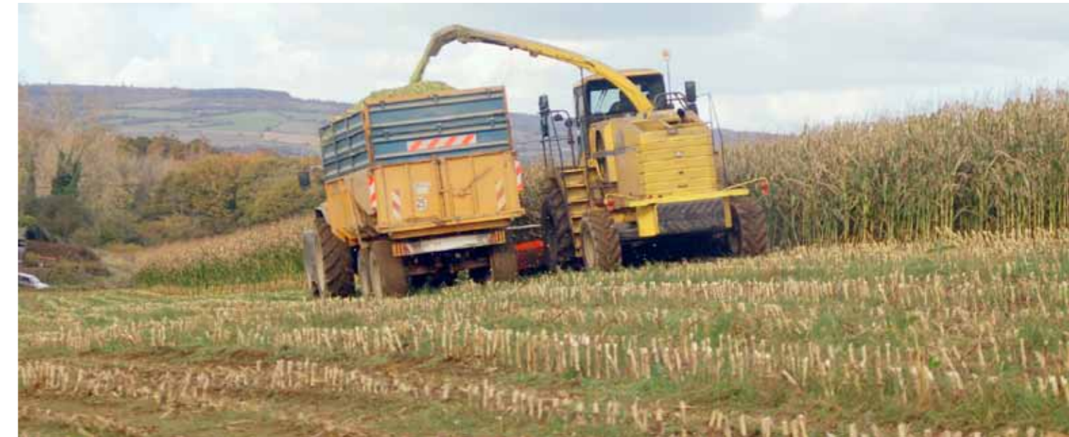
Die Ernte auf zu feuchtem Boden kann zu Schadverdichtung führen
