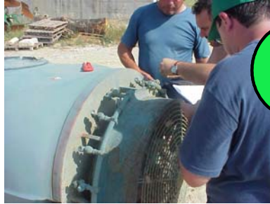
Verifica tipo ugelli
