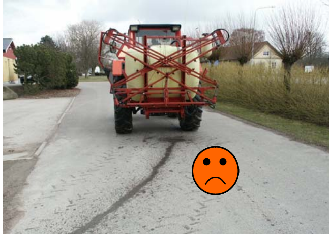
Fig. 2 – Perdite di prodotto dall'irroratrice durante il trasferimento in campo (foto E. Nilsson – Visavi)
