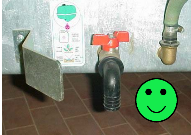
Fig. 29 - Rubinetto per la raccolta in sicurezza della miscela residua nel serbatoio
