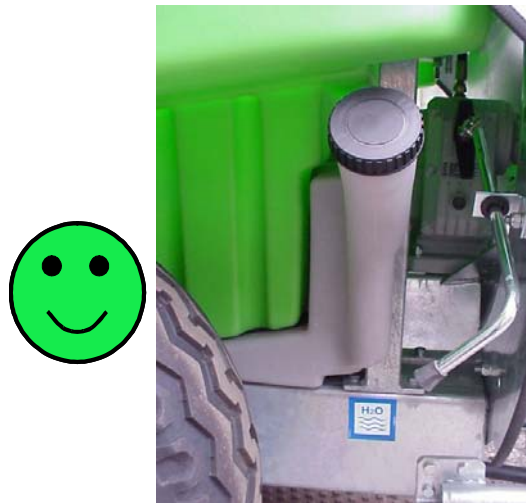
Fig. 26 – Il serbatoio lavaimpianto deve avere almeno il 10% della capacità nominale del serbatoio principale o almeno 10 volte il volume diluibile. La sua presenza consente di effettuare in campo il lavaggio dell'irroratrice e lo smaltimento della miscela residua nel serbatoio principale. Deve essere progettato in modo da consentire il risciacquo delle tubazioni anche con il serbatoio principale pieno e la diluizione del residuo all'interno dello stesso.
