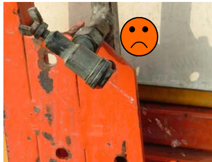
Fig. 21 - Esempio di ugello NON dotato di dispositivi antigoccia (sinistra) e di antigoccia non funzionante (destra).
