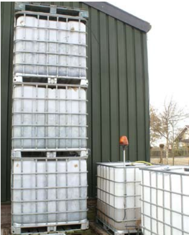
Het biofilter bestaat uit drie tweedehands plastic bakken waarin een mengsel van potgrond, stro en grond van het perceel zit. Water dat eronder uitstroomt, is volgens de eerste onderzoeken helemaal schoon.
