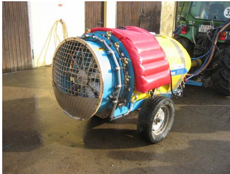
Figura 1 – Esempio di serbatoio ausiliario per l'acqua pulita aggiunto su una macchina irroratrice che originariamente ne era priva.
