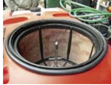
Figura 8 – Esempio di ugello lavabarattolo montato sull'apertura del serbatoio principale dell'irroratrice
