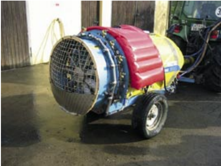
Figura 5 – Esempio di serbatoio ausiliario per l'acqua pulita aggiunto su una macchina irroratrice che originariamente non ne aveva.
