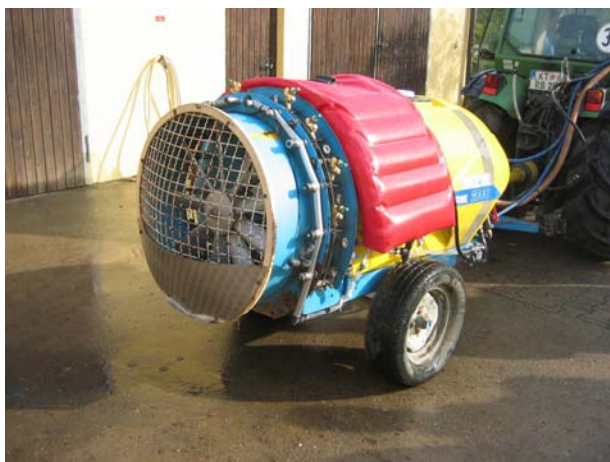
Figura 20 – Esempio di serbatoio ausiliario per l'acqua pulita aggiunto su una macchina irroratrice che originalmente ne era priva.
