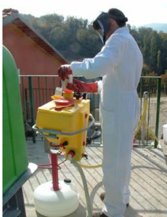
Figura 17 – Impiego di un dispositivo pre-miscelatore indipendente per l'inserimento del prodotto fitosanitario nel serbatoio principale dell'irroratrice.
