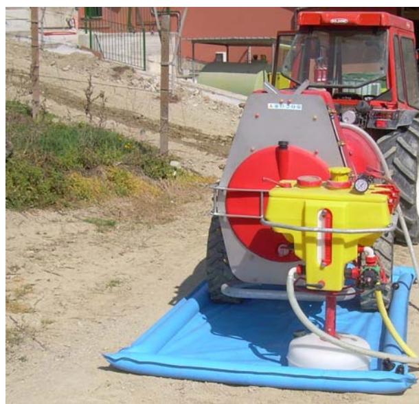
Figura 16 – Telo di plastica e pre-miscelatore indipendente impiegabili durante le operazioni di riempimento della macchina irroratrice.
