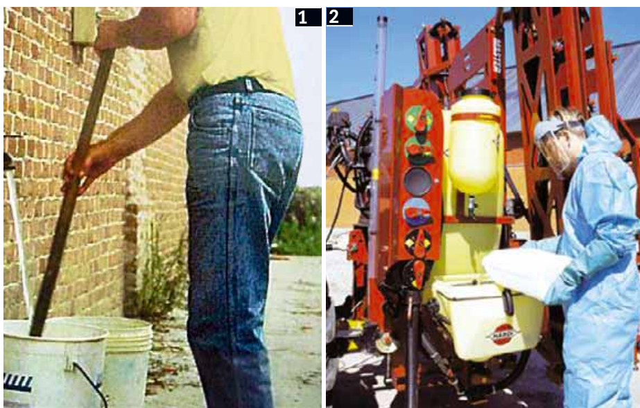
Preparazione della miscela fitoiatrica senza impiego di adeguata attrezzatura (foto 1) e mediante utilizzo di premiscelatore (foto 2)
