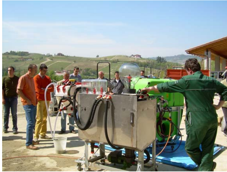
Figura 1. Banco prova per l'illustrazione del funzionamento del pre-miscelatore e degli ugelli lavabarattoli utilizzato per le dimostrazioni presso l'azienda Fontanafredda.
