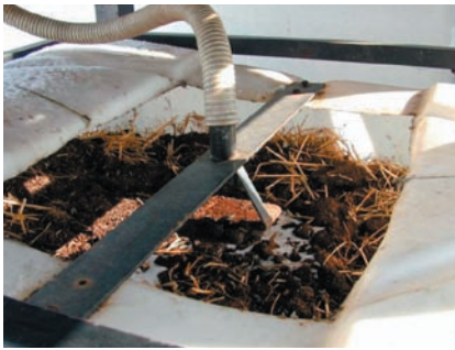
21–22. ábra: A szennyezett folyadék felületen való szétosztása fém lappal (balra, Forrás: CRAw) vagy perforált csőhurokkal (jobbra, Forrás: pcfruit)
