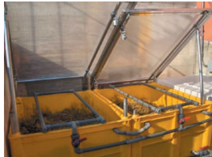
25–26 ábra: A beton helyett a bioágyat műanyaggal is lehet szigetelni, EPDM (balra, Forrás: ADAS) és PE tartályok (jobbra, Forrás: Mybatec)
