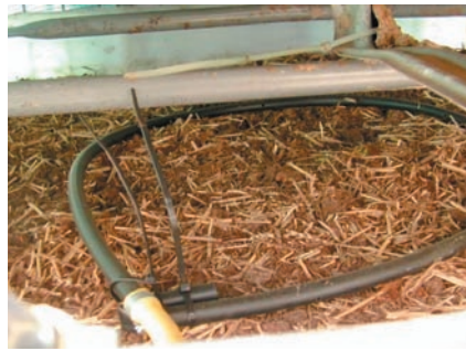
21–22. ábra: A szennyezett folyadék felületen való szétosztása fém lappal (balra, Forrás: CRAw) vagy perforált csőhurokkal (jobbra, Forrás: pcfruit)
