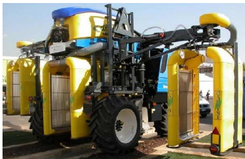
Fig. 63 - Esempi di irroratrici con sistema di recupero del liquido che oltrepassa il filare.
