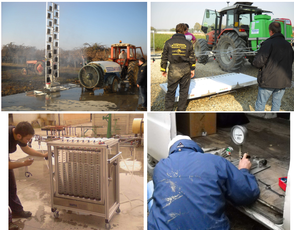
Fig. 25 – Esempi di alcune fasi di esecuzione del controllo funzionale su macchine irroratrici in uso.
