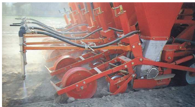
Fig. 59 – Irroratrice per diserbo localizzato abbinata a seminatrice.
