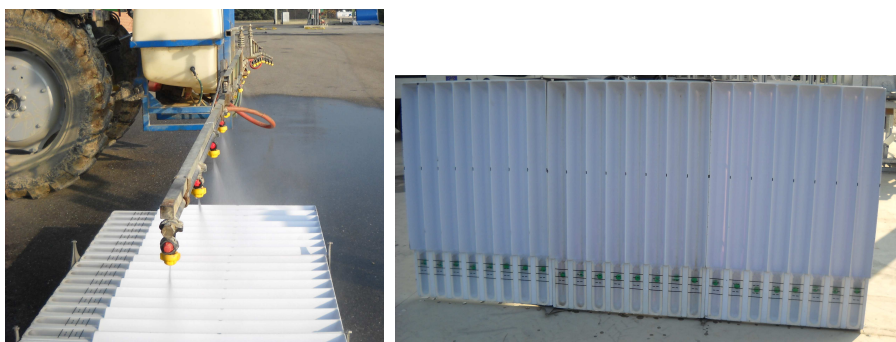
Fig. 72 - Attrezzatura utilizzata per misurare la qualità della distribuzione trasversale.
