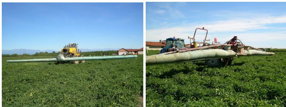
Fig. 69 - Barre irroratrici equipaggiate con manica d'aria
