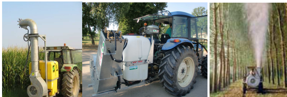
Fig. 73 - Esempi di irroratrici a cannone, molto sensibili alla deriva
