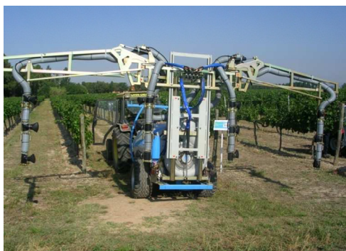
Fig. 64 – Irroratrice scavallante che tratta due filari completi per volta.
