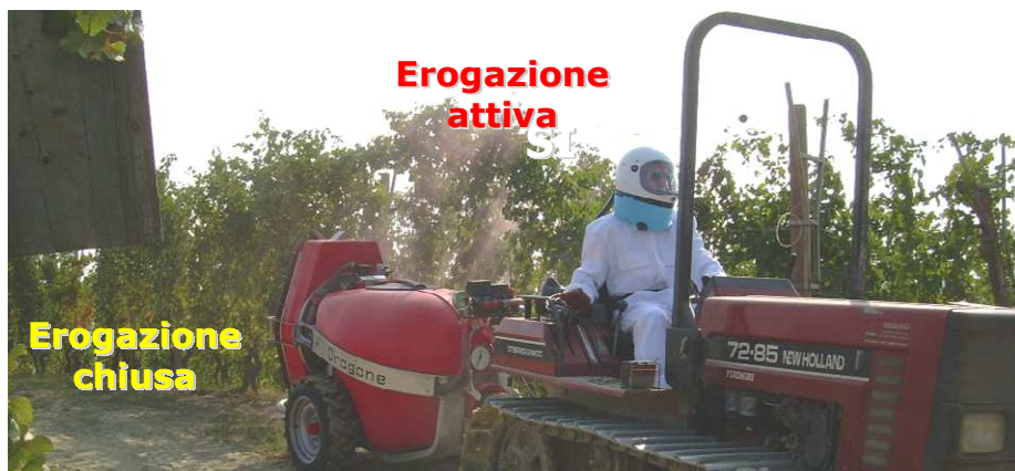
Fig. 37 – Interruzione dell'erogazione sul lato esterno dell'ultimo filare dell'appezzamento.
