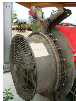
Fig. 71 – Deflettori dell'aria su ventilatore assiale.
