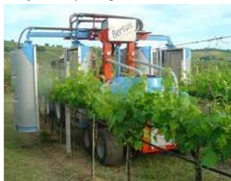
Fig. 63 - Esempi di irroratrici con sistema di recupero del liquido che oltrepassa il filare.
