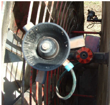
Fig. 82 - Esempio di ugello rotativo per atomizzatori
