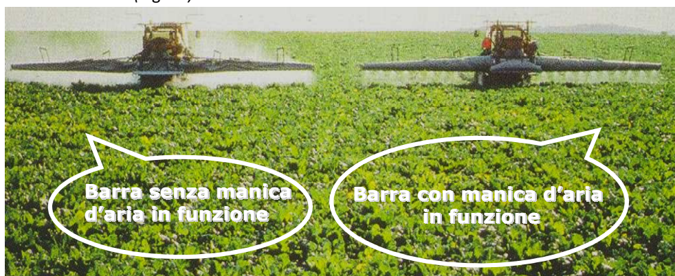
Fig. 56 – Distribuzione senza e con attivazione della manica d'aria.
