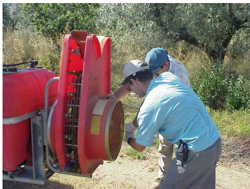
Fig. 49 – Regolazione dell'inclinazione delle pale.
