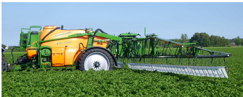
Fig. 58 – Il crop tilter apre la vegetazione per favorire una migliore penetrazione delle gocce (foto: http://www.vibyteknik.se )
