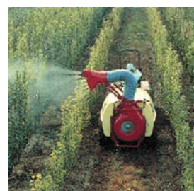
Fig. 41 – Irroratrice con cannone impiegata in vigneto.
