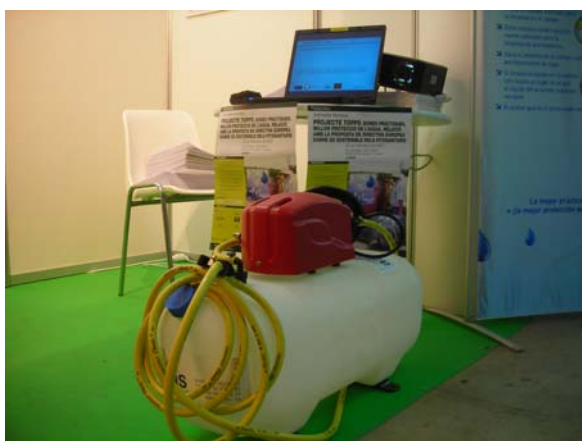
Tanque de água limpa com lança para lavagem exterior do pulverizador (Fonte: UPC)
