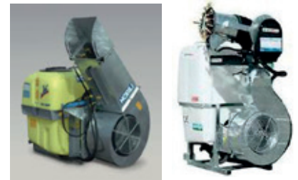
Fig. 19 : Pulvérisateur canon très vulnérable à la dérive
