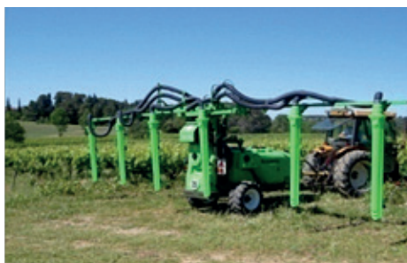
Fig. 21 : Pulvérisateur multi-rangs, a) avec buses b) avec canons
