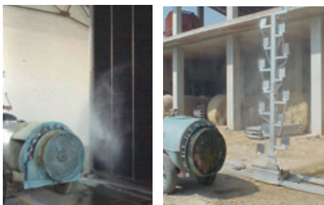
Fig. 10 : Deux exemplaires de bancs de répartition verticale
