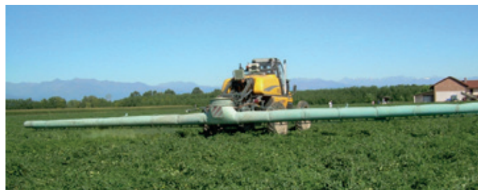
Fig. 24 : Pulvérisateur avec manchon d'air
