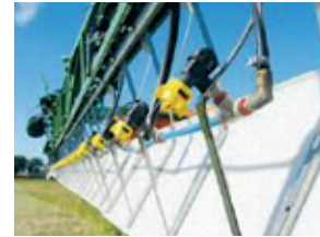
Figura 22: Los elementos mecánicos abren el cultivo para una mejor penetración del producto.
