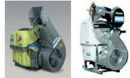
Fig. 18: Cañón de pulverización, muy vulnerable a la deriva
