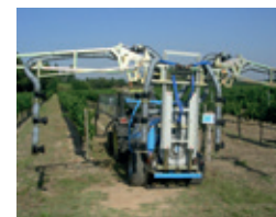
Figura 26: Pulverizador que envuelve toda la hilera de vegetación
