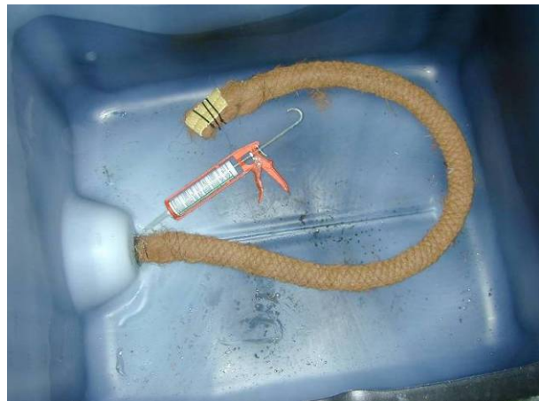
Fig 27: tubo de dreno no fundo de um biofilter.
