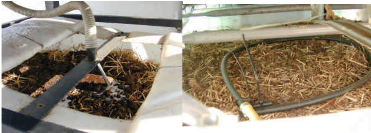
Fig. 21 y 22: Distribución uniforme del líquido contaminante en la superficie del biofilter utilizando una plancha metálica (izquierda, fuente CRAw) o una manguera agujereada (derecha, fuente pcfruit).
