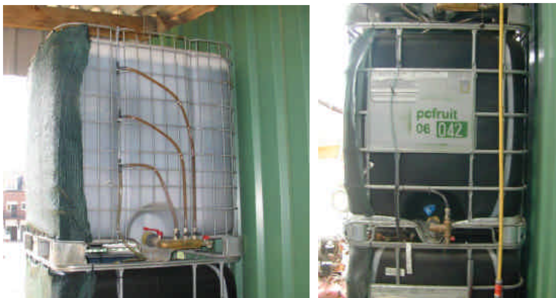
Fig. 35 y 36: Para conseguir un adecuado contenido de humedad en las dos unidades superiores de este biofilter modificado, se mantiene en la parte baja de cada unidad una zona saturada de humedad de forma que permita al agua ascender por capilaridad. Esto puede conseguirse conectando a la salida de la unidad una tubería que se dobla hacia arriba. La altura de la zona saturada viene determinada por la altura a la que llega el agua en la tubería dispuesta en posición ascendente. Diferentes alturas pueden habilitarse (izquierda). Conectar a su vez el final de la tubería con la siguiente unidad de biofilter (figuras 21-24).
