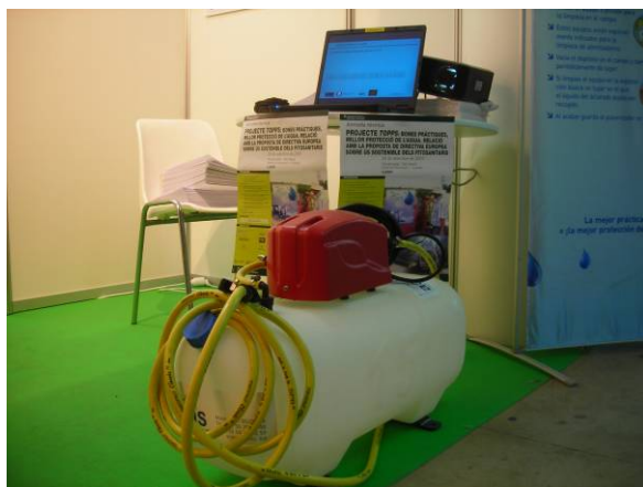
Zbiornik na czystą wodę z łańcuchem ciśnieniowym do mycia zewnętrznego opryskiwacza (Źródło: UPC)
